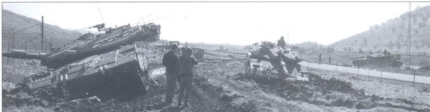
Говорят, танки грязи не боятся. К «Меркаве» это не относится. Тяжелый танк застревает в мягком грунте даже после небольшого дождя. Ведь «Меркава» создана для пустынной местности!
